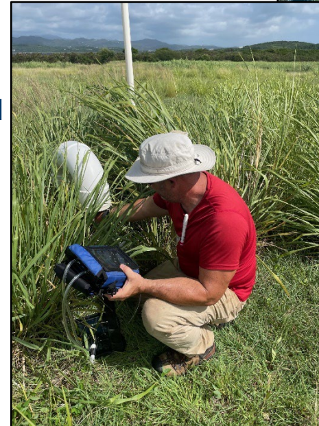
Monitoreo del gas en el relleno sanitario de SWMU 3
