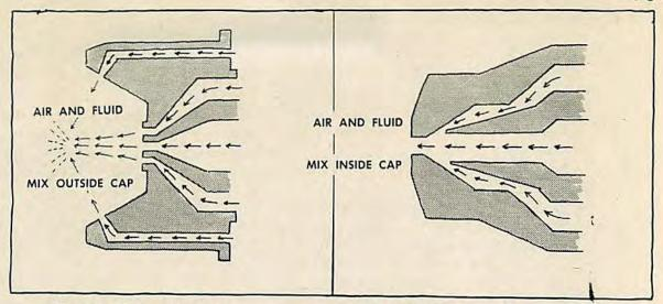
Fig. 16. External mix air cap.
