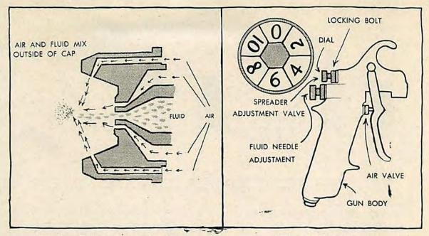
Fig. 22. External mix air cap.
