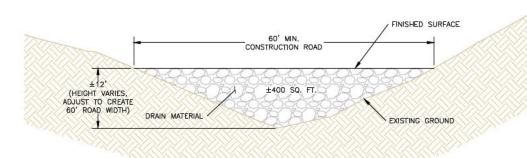
C FINGER DRAIN - TYPICAL SECTION
