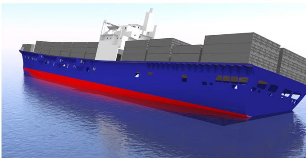
Ilustracja 9. Obraz komputerowy EL FARO pokazujący statek z 15-stopniowym przechylem na prawą burtę i przegłębieniem w stronę rufy 5,8 stóp (1,76 m) z powodu zalania ładowni 3, szacowanego na 20% i przechylem w wyniku wiatru. Ilustracja dostarczona przez Centrum Bezpieczeństwa Morskiego USCG.
