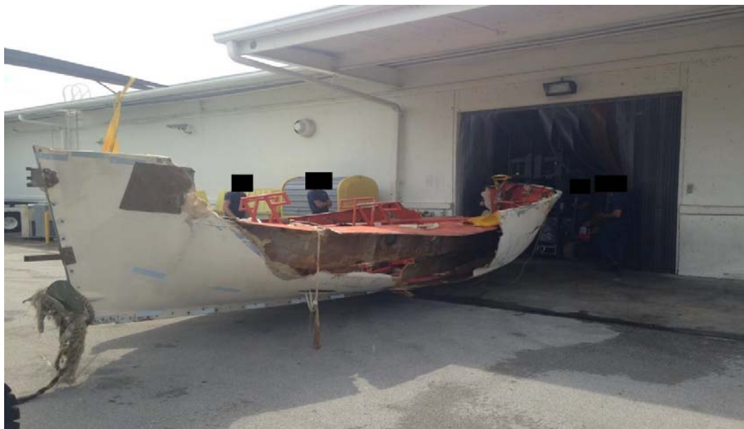
Ilustracja 65. Łódź Ratunkowa na sterburcie EL FARO. Widoczne są duże uszkodzenia sterburty łodzi ratunkowej. Fotografia wykonana w Bazie Powietrznej Miami Straży Przybrzeżnej.
