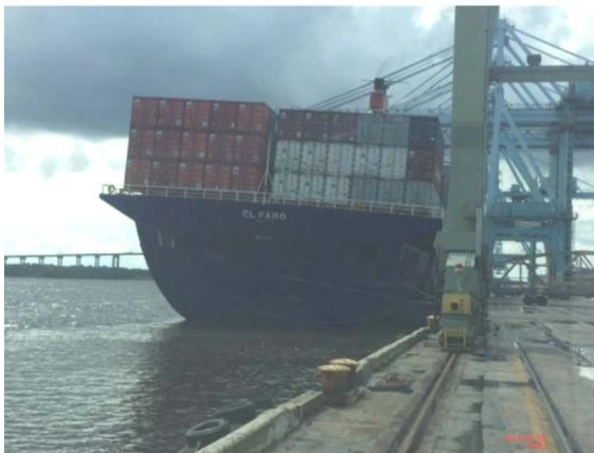
Ilustracja 3. Zdjęcie zrobione przez Kierownika Terminala TMPR w dniu 29 września 2015 r., pokazujące przechylenie prawej burty o 4 stopnie podczas operacji załadunku przed wyruszeniem
