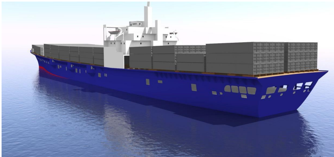
Ilustracja 4. Obraz komputerowy EL FARO pokazujący statek w gotowości do wypłynięcia ze średnim zanurzeniem 30,1 stóp (9,7 m), 0 stopni przechyłu i przegłębieniem w stronę rufy 5,0 stóp (1,52 m). Ilustracja dostarczona przez Centrum Bezpieczeństwa Morskiego USCG.
