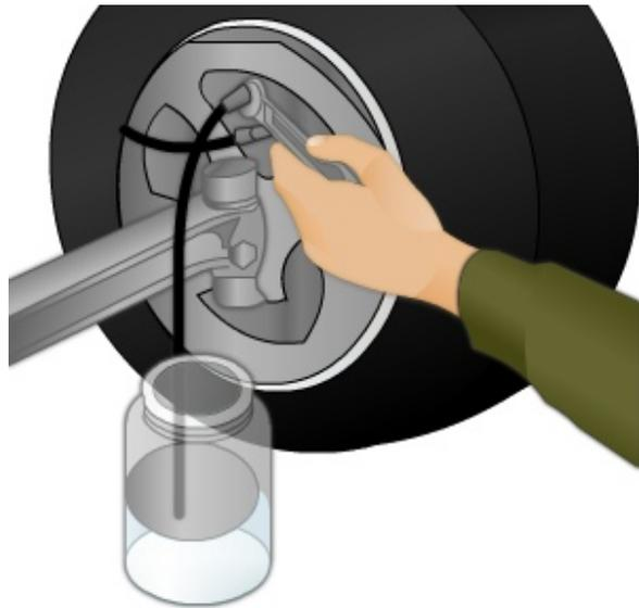
**Figure 13-22 — Manual bleeding brake lines.**
