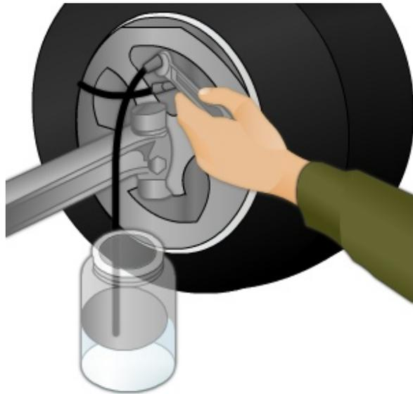
**Figure 13-22 — Manual bleeding brake lines.**
