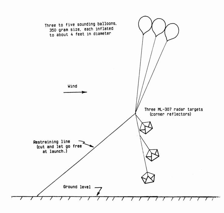
TYPICAL RADAR TARGET FLIGHT TRAIN USED BY THE NYU BALLOON GROUP IN 1947
